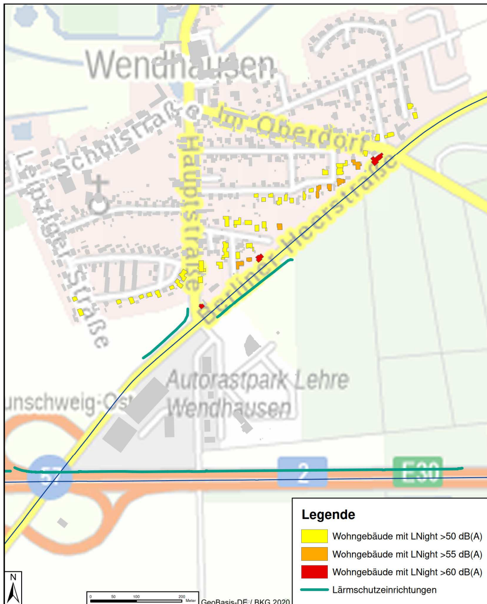
Abbildung 2: Betroffene Wohngebäude (Straßenverkehrslärm nachts) an der L295 in Wendhausen
